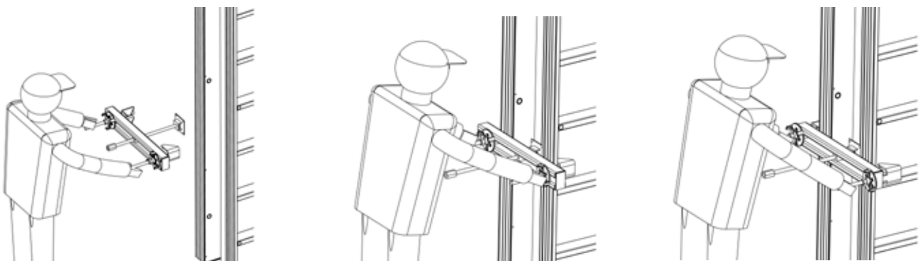
Fig. 15b : Mise en place traverse d'about
